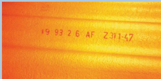
Bild 8 Asbestfreie Faserzementwelltafel mit Herstellungsdatum, „AF“-Kennzeichnung (asbestfrei) und Nummer der allgemeinen bauaufsichtlichen Zulassung des DIBt [C.3]
