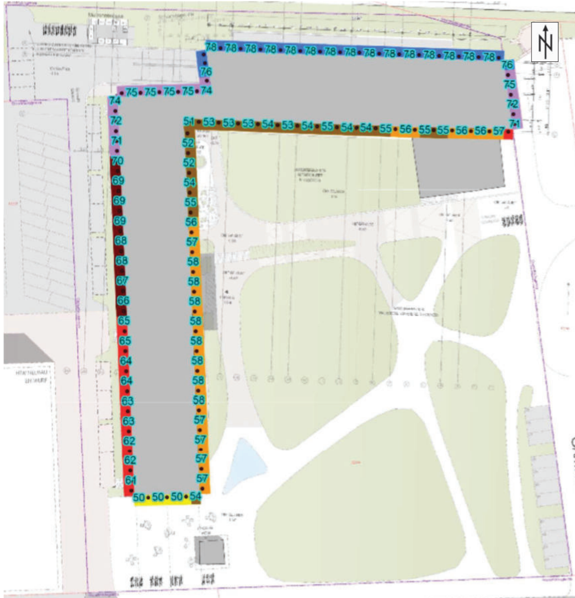
Bild 4c Gebäudelärmkarte Verkehrsgeräuschimmissionen tags – 2. OG Maßstab ca. 1:750
