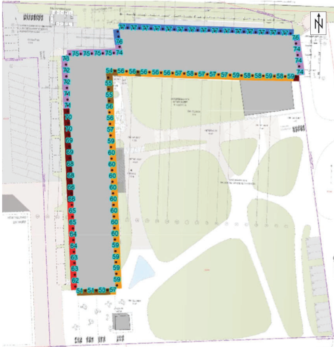
Bild 4e Gebäudelärmkarte Verkehrsgeräuschimmissionen tags – 4. OG Maßstab ca. 1:750
