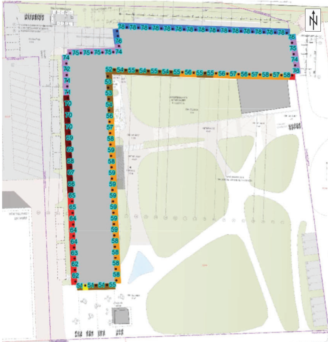
Bild 4d Gebäudelärmkarte Verkehrsgeräuschimmissionen tags – 3. OG Maßstab ca. 1:750
