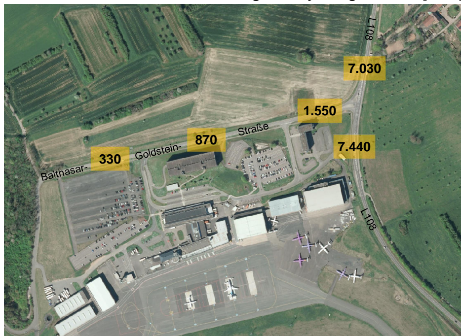
Bild B1 Querschnittsbelastungen Analyse Tagesverkehr [Kfz/d]
