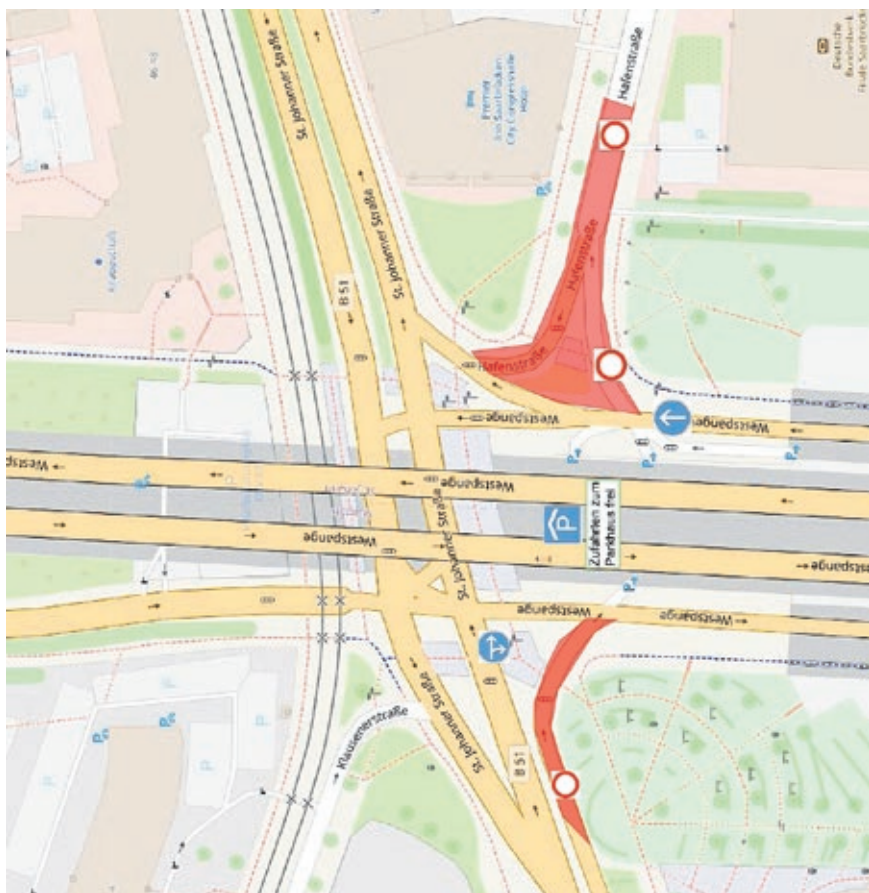
Sperrungen für den Verkehr während des ersten Bauabschnitts für den Kreisverkehr unter der Westspange. Grafik: WSV Beratende Ingenieure GmbH
